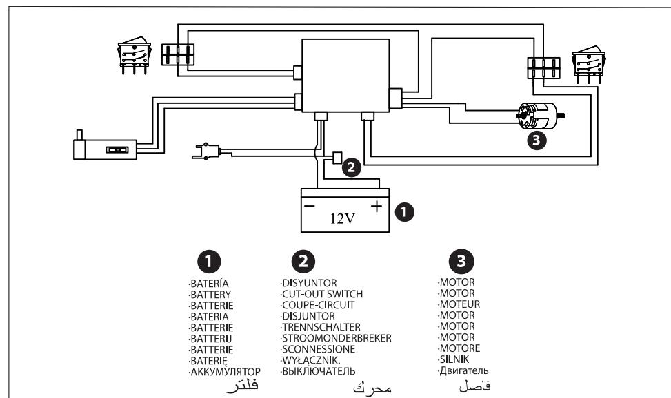
• SUSTITUCIÓN DE LA BATERÍA USADA • REPLACING A USED BATTERY • REMPLACEMENT DE LA BATTERIE USÉE • SUBSTITUIÇÃO DA BATERIA USADA • AUSWECHSELN DER GEBRAUCHTEN BATTERIE • VERVANGING VAN DE GEBRUIKTE BATTERIJ • SOSTITUZIONE DELLA BATTERIA SCARICA • WYMIANA ZUŻYTEGO AKUMULATORA • ЗАМЕНА АККУМУЛЯТОРА . استبدال البطاریہ .
